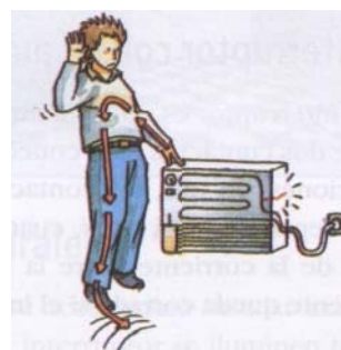
Fuga de corriente sin toma de tierra.
