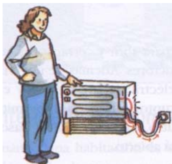
Fuga de corriente con toma de tierra
